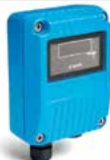
Rivelatori di fiamma a triplo IR - Intrinsically Safe (IS) Necessita di 4x Barriere Zener mod. Z928 (pag.50, 123) SU RICHIESTA
