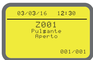
Segnalazione guasto/anomalia GIALLO
